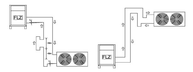
Maximális nyomvonal hossz: 30 m. Egyéb esetben kérjük forduljon kollegáinkhoz.
